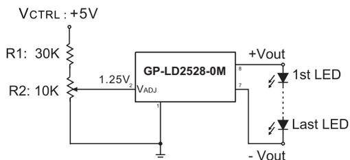
$$V_{ADJ} = \frac{R2}{R1 + R2} \times V_{CTRL}$$
