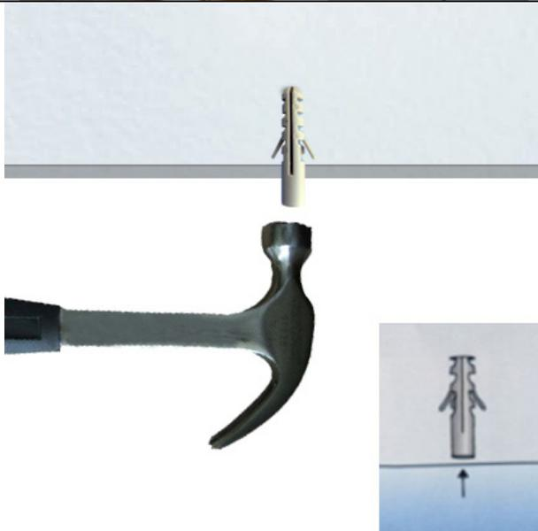
將膨脹螺絲塞放入鑽孔處
